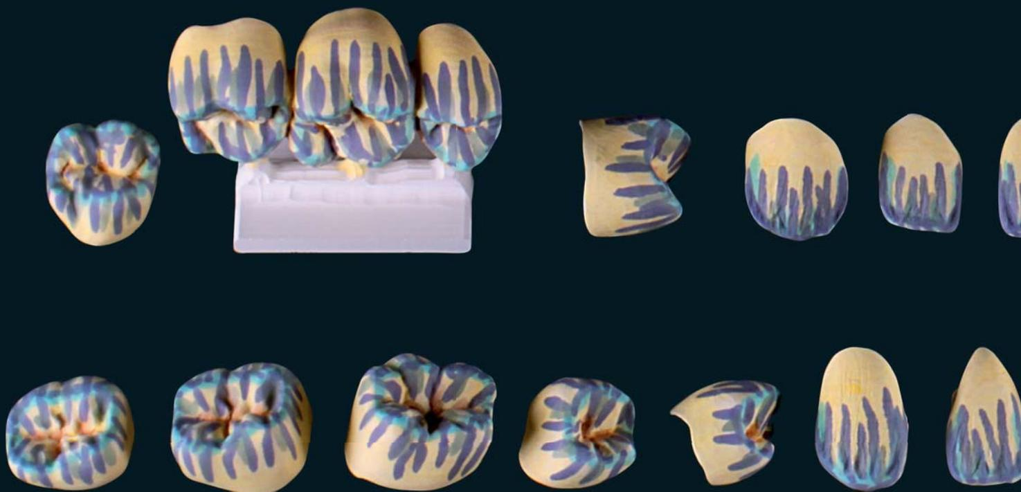
*Le strutture sono state colorate con Colour Liquid Prettau® Anterior® Aquarell.*
